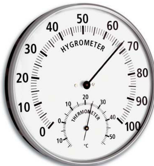
Termo-/hygrometer Typ: SL452019. Mätområde: 0 ... 100 % Rf. Noggrannhet: +/- 5 %. Mätelement: Hår syntetiskt. Mätområde: -15 ... +55°C. Dimension: Ø 130 mm. Med förkromad mässingsring. Vikt: 225g.
