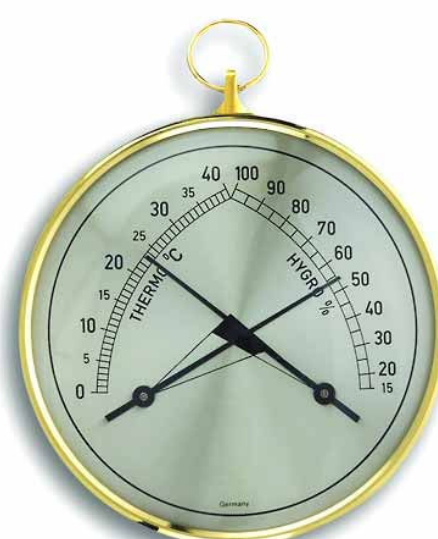
Termo-/hygrometer Typ: SL452005. Mätområde: 15 ... 100 % Rf. Noggrannhet: +/- 8 %. Mätområde: 0 ... +40°C. Mätelement: Bimetall. Dimension: Ø 100 mm. Med förkromad mässingsring. Vikt: 90g.
