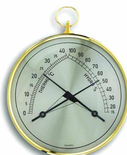
Termo-/hygrometer Typ: TFA 45.2005. Mätområde: 15 ... 100 % Rf. Noggrannhet: +/- 8 %. Mätområde: 0 ... +40°C. Mätelement: Bimetall. Dimension: Ø 100 mm. Med förkromad mässingsring. Vikt: 90g.
