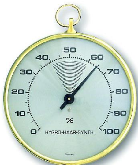
Hygrometer Typ: TFA 44.2001. Mätområde: 0 ... 100 % Rf. Noggrannhet: +/- 5 %. Mätelement: Hår syntetiskt. Dimension: Ø 100 mm. Med förkromad mässingsring. Vikt: 105g.
