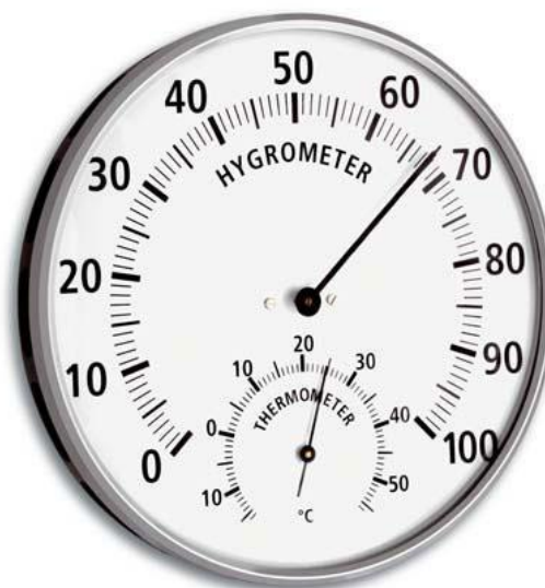
Termo-/hygrometer Typ: TFA 45.2019. Mätområde: 0 ... 100 % Rf. Noggrannhet: +/- 5 %. Mätelement: Hår syntetiskt. Mätområde: -15 ... +55°C. Dimension: Ø 130 mm. Med förkromad mässingsring. Vikt: 225g.
