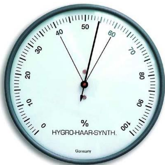
Hygrometer Typ: TFA 44.2003. Mätområde: 0 ... 100 % Rf. Noggrannhet: +/- 5 %. Mätelement: Hår syntetiskt. Dimension: Ø 100 mm av plast. Vikt: 105g.
